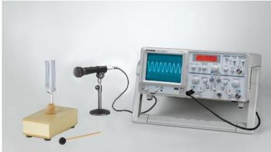
▲ Hình 13.4. Bố trí thí nghiệm quan sát đồ thị dao động âm
