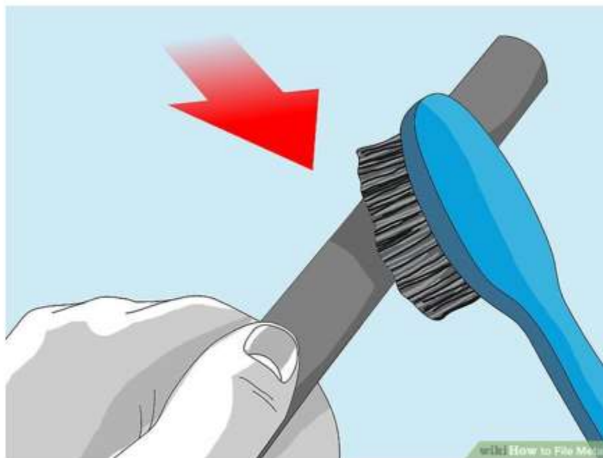
Hình 51. Sử dụng dụng cụ để gạt phoi trên kim loại
