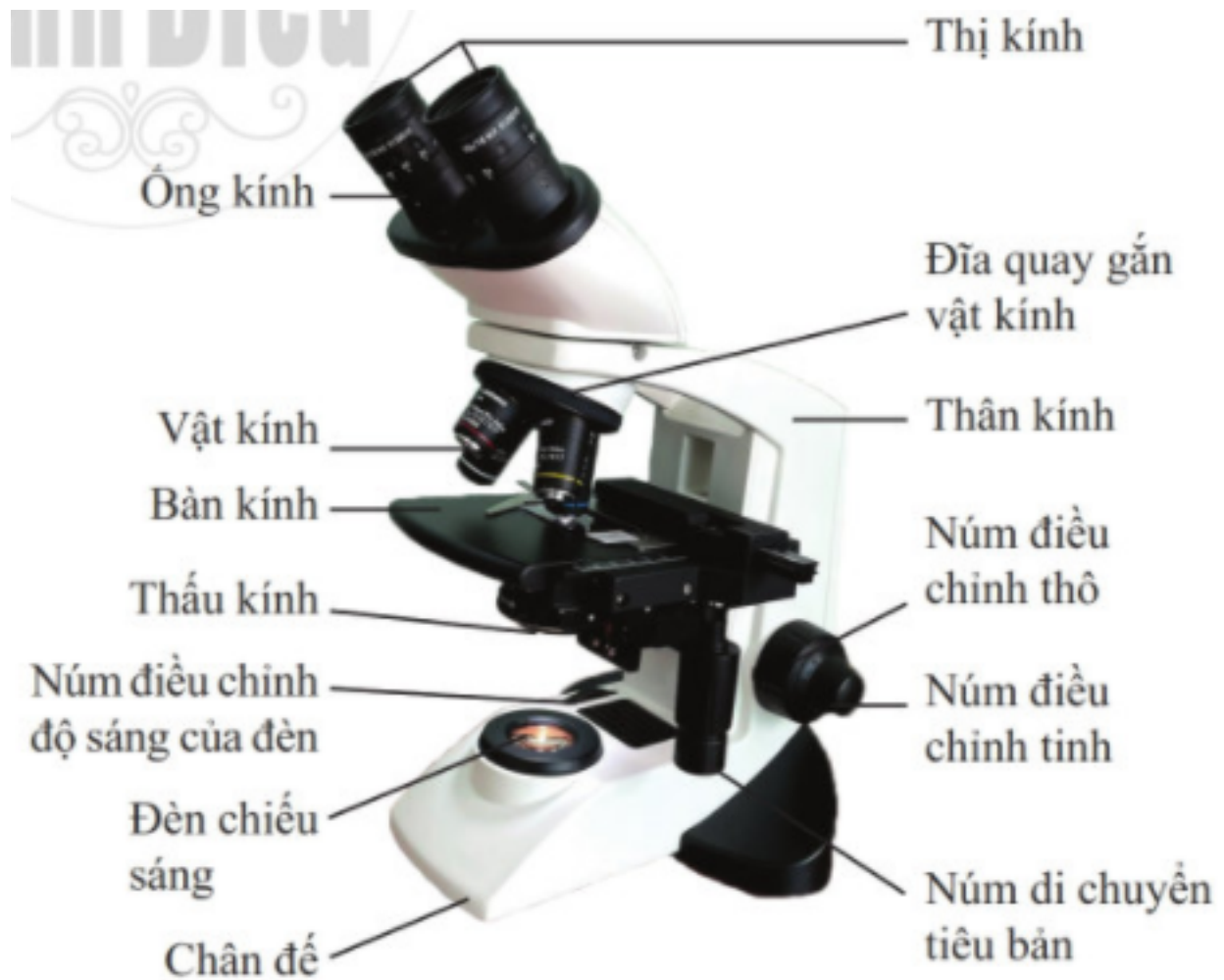
Hình 2.7. Cấu tạo kính hiển vi quang học
