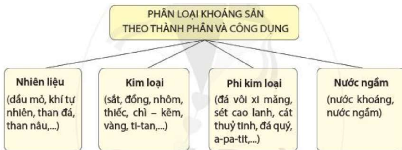
Hình 11.9. Sơ đồ phân loại khoáng sản theo thành phần và công dụng
