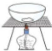
Hình 11.1. Các bước tách muối ra khỏi dung dịch nước muối
