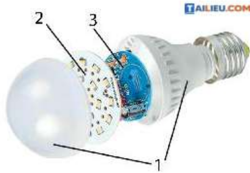
Hình 9.4. Cấu tạo của đèn LED
