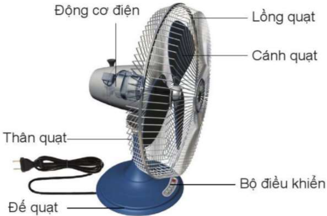
Hình 14.2. Cấu tạo của quạt điện
