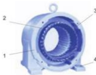
Hình 26 – 3. Hình dạng stato 1. Vỏ máy ; 2. Lõi thép ; 3. Dây quấn ; 4. Chân đế.
