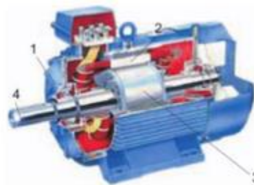
Hình 26 – 1. Cấu tạo động cơ không đồng bộ ba pha 1. Nắp máy ; 2. Stato ; 3. Rôto ; 4. Trục quay.
