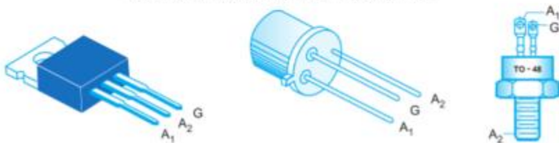
Hình 4 – 7. Hình dạng, cách bố trí chân của triac
