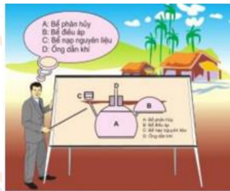
Hình 34.4. Sơ đồ hệ thống biôga xử lý chất thải trong chân nuôi
