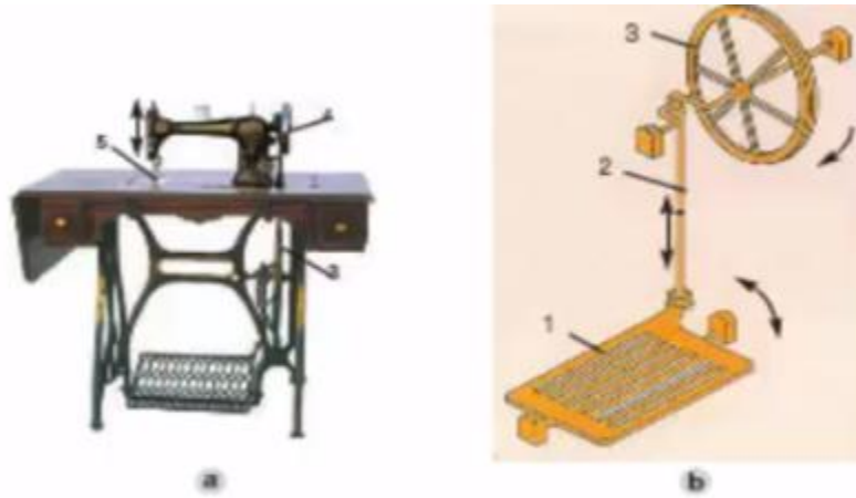
Hình 30.1. a) Máy khâu đạp chân; b) Cơ cấu truyền và biến đổi chuyển động 1. Bàn đạp; 2. Thanh truyền; 3. Vô lăng cần; 4. Vô lăng bị dẫn; 5. Kim máy
