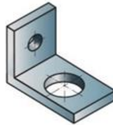
Hình 5.4. Hình chiếu trục đo vuông góc đều được ứng dụng để biểu diễn các vật thể có các lỗ tròn.
